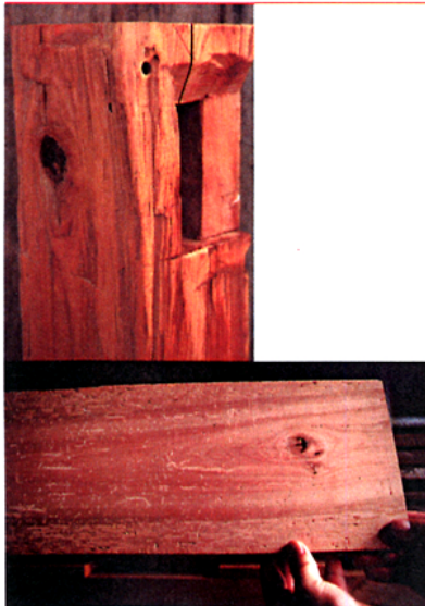
上/ほぞ穴や洋釘を抜いた跡が残り、表面を手斧で荒削りした風合いが古材らしい。下/ニレ材表面の小さな傷は、古い虫食いの跡。薫蒸を施し実際に支障はない。
